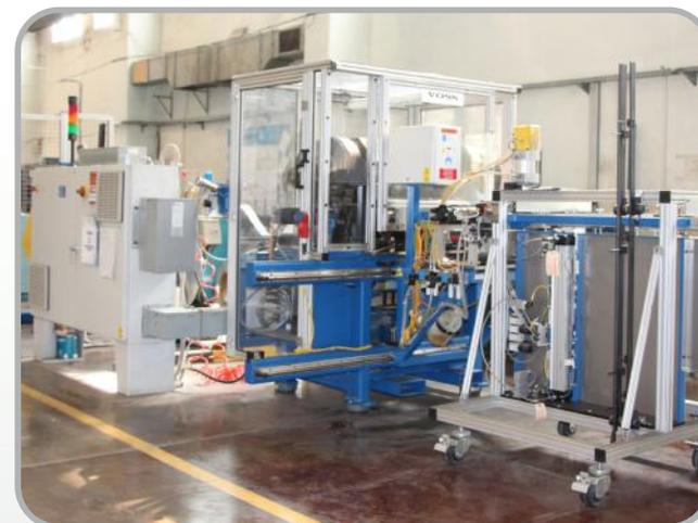
Линия изготовления охлаждающих пластин - фирма «Voss Manufacturing Inc» (США)
