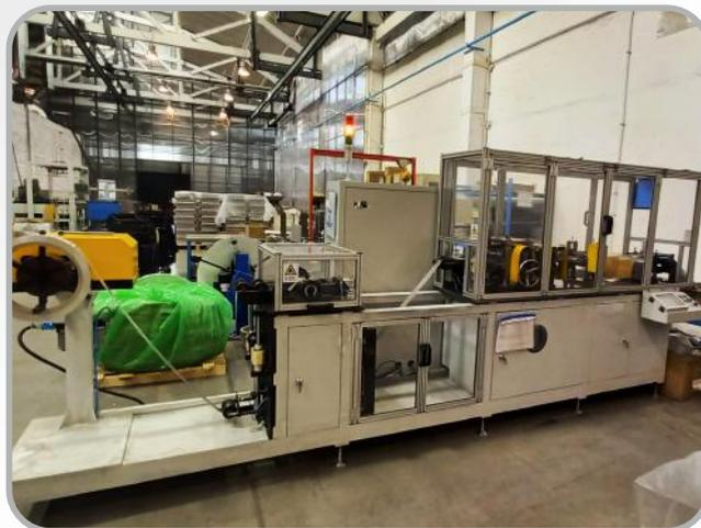
Линия изготовления охлаждающих пластин -
