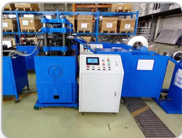
Станок для штамповки деталей остова -
