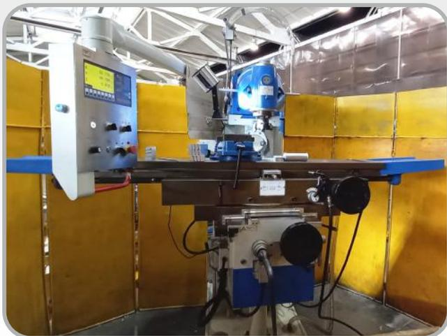
Вертикально-фрезерный станок с ЧПУ -
