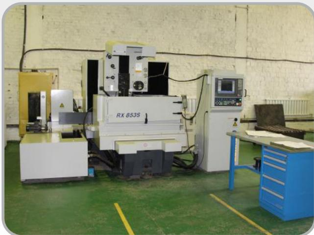
Электроэрозионный станок с ЧПУ, супердрель - фирма «SHMER» (Тайвань)
