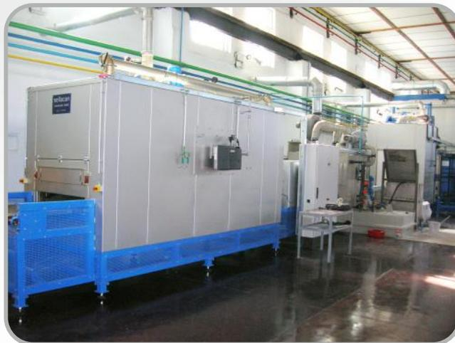
Установка термического обезжиривания - фирма «Sellacan» (Германия)
