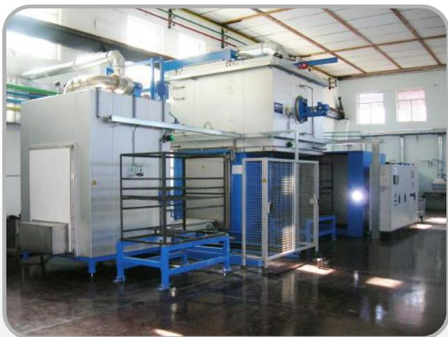
Печи пайки камерного типа - фирма «Sellacan» (Германия)
